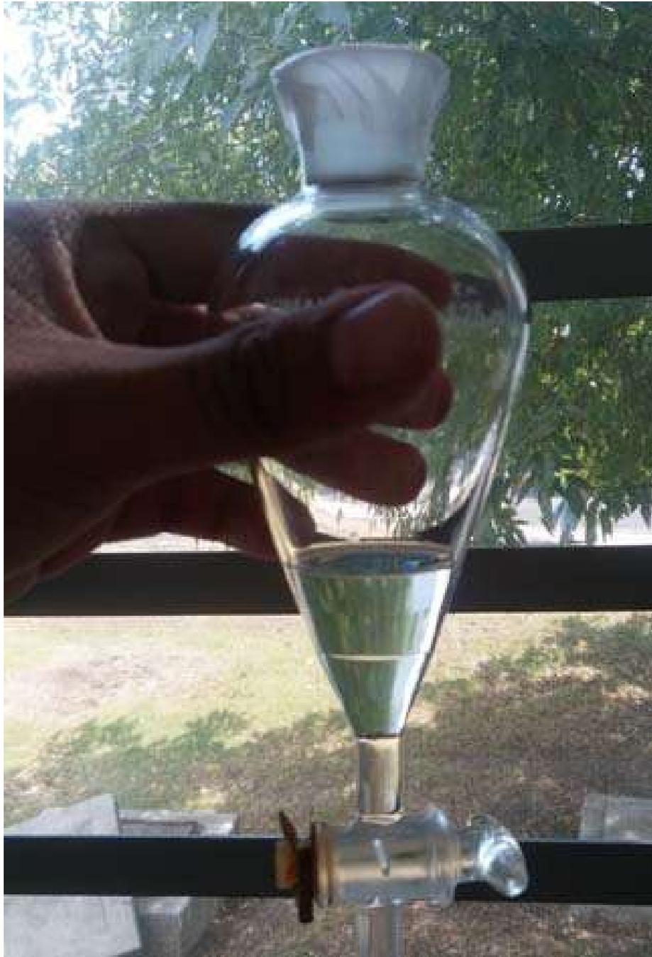
*Fig. 21 Mezcla Etanol-Agua-K<sub>2</sub>HPO<sub>4</sub>*
