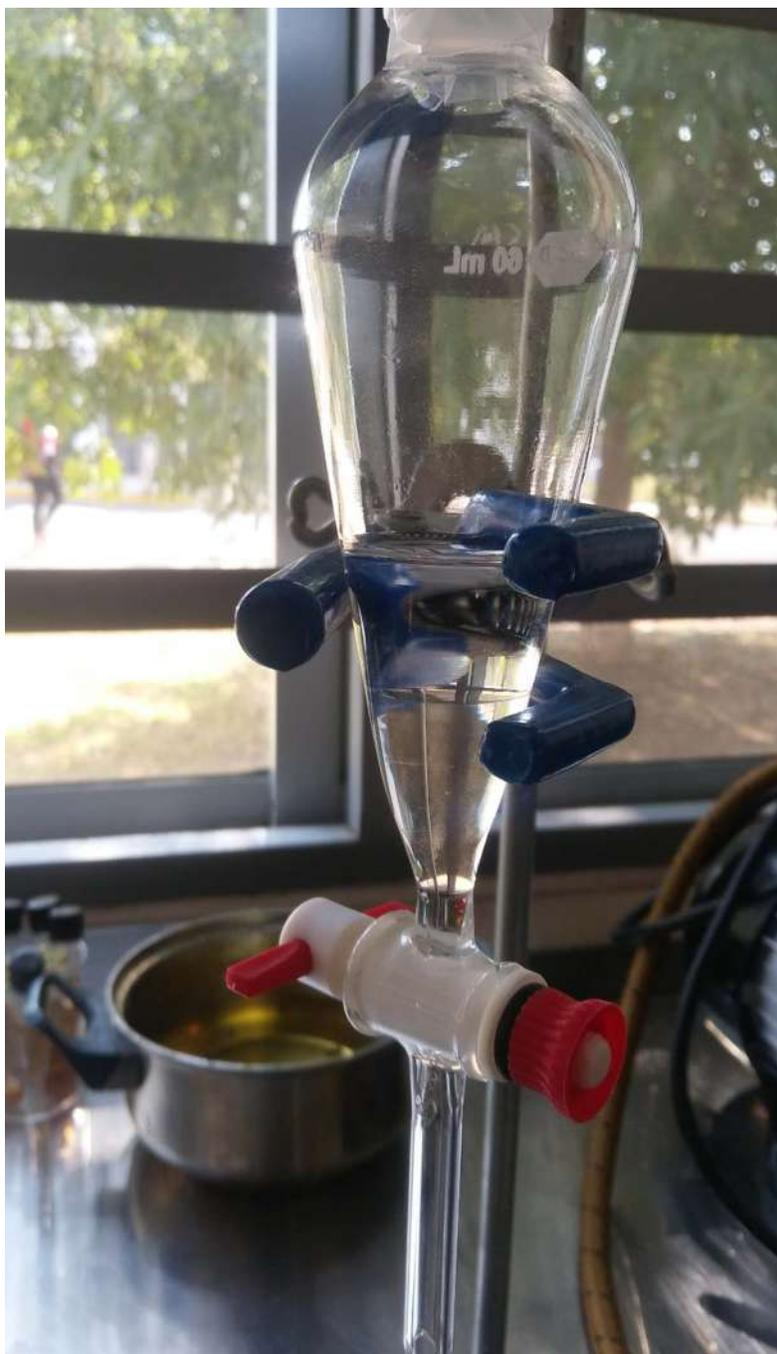
*Fig. 23 Mezcla Etanol-Agua- $K_3PO_4$*
