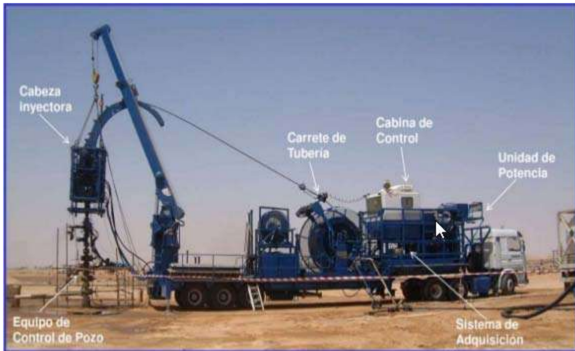
Figura 19.- Equipo de tubería flexible (Hernandez, Mireles, Mireles, & González, 2018).
