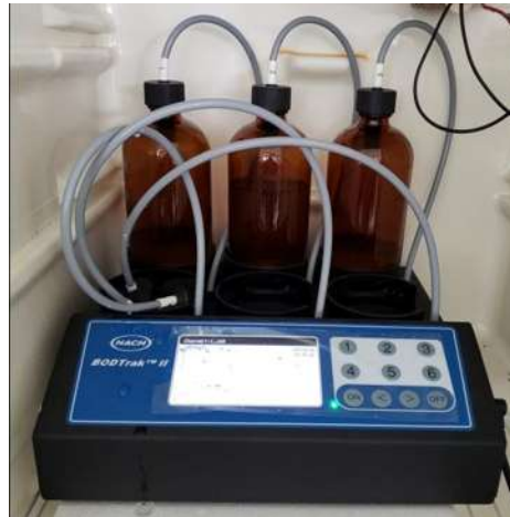
Figura 3.10. Equipo BOD Track II marca Hach, método respirométrico para pruebas de consumo de oxígeno por biodegradabilidad.
