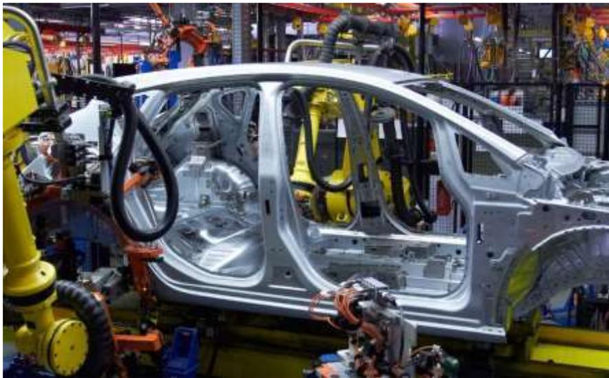
Figura 1.2 Vehículo en área de estampados (acabado metálico).
