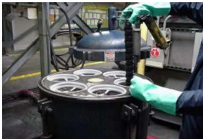
Figura 1.5. Olla filtro de las etapas de desengrase en el pretratamiento metálico con imanes saturados de finos metálicos.
