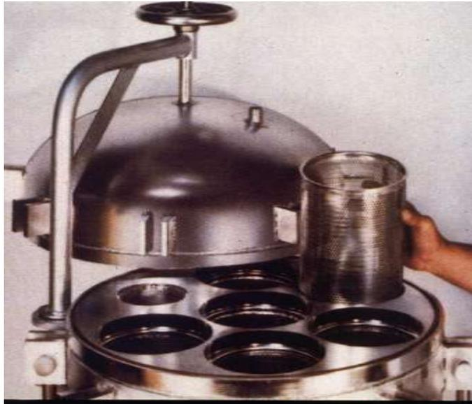
Figura 1.6. Olla filtro de las etapas de desengrase en el pretratamiento metálico mostrando el housing.
