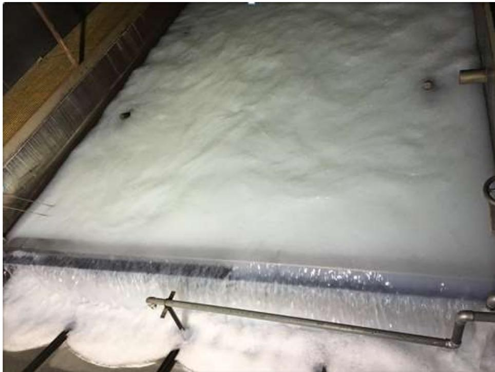
Figura 3.13. Tanque de proceso con el material acondicionador versabond.
