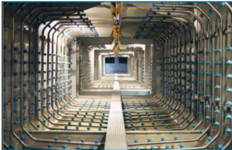
Figura 1.3. Ejemplo de arillo de aspersion en el proceso de pretratamiento.
