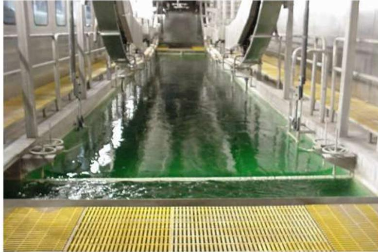
Figura 1.14. Imagen de un tanque de proceso del fosfato de zinc.
