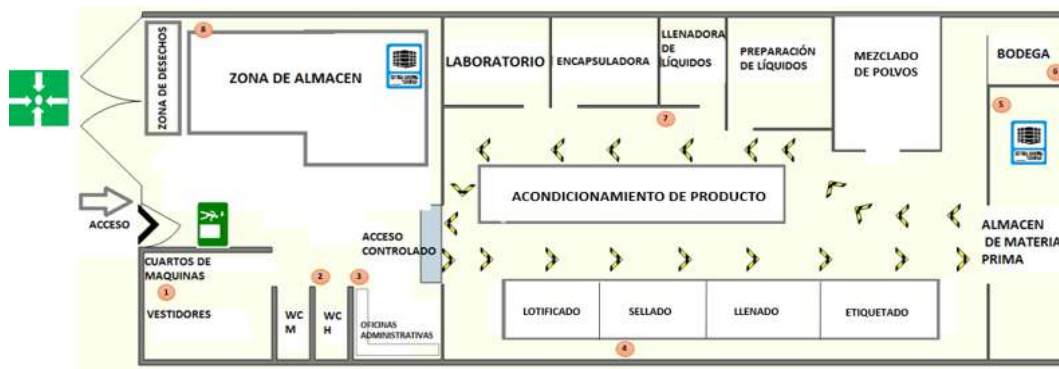
Ilustración 195 Lay out de extintores
