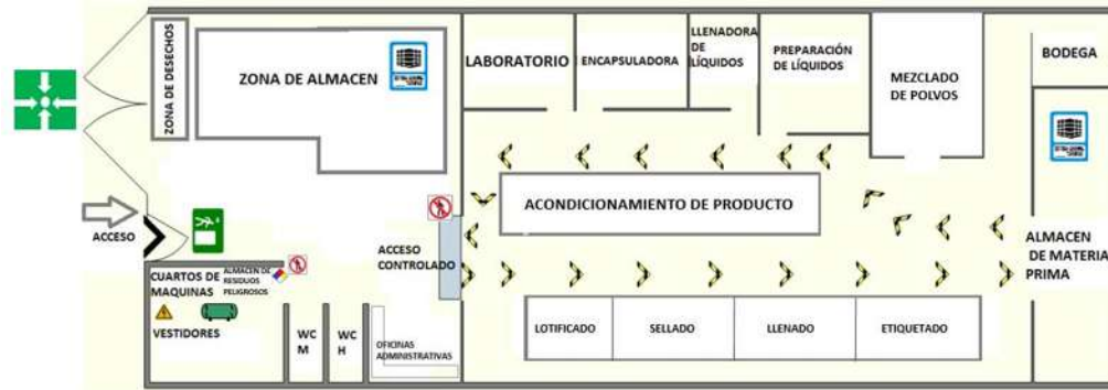
Ilustración 196 Lay out salidas de emergencia
