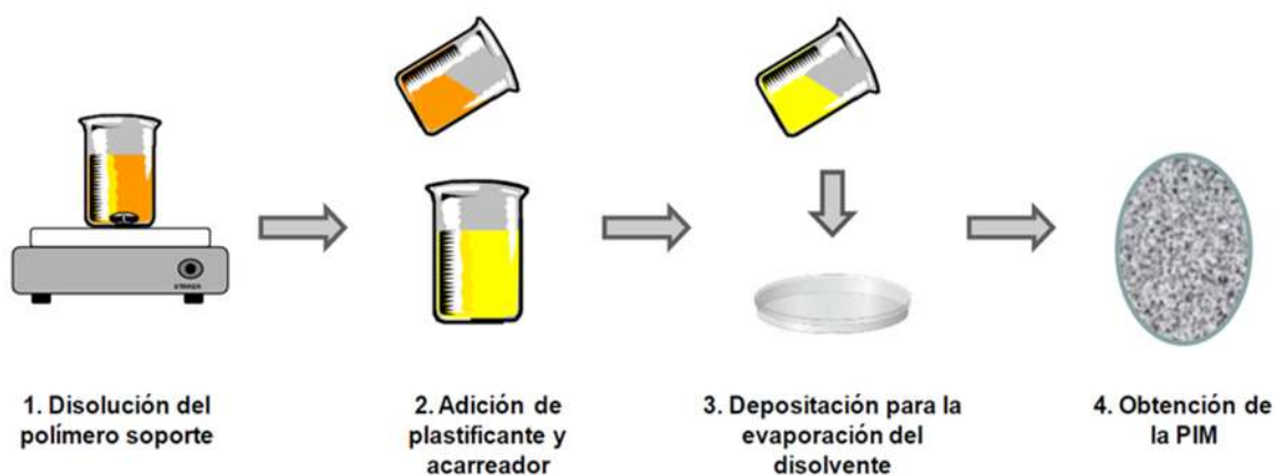
Figura 9. Esquema general para la elaboración de la membrana polimérica de unclusión (PIM).
