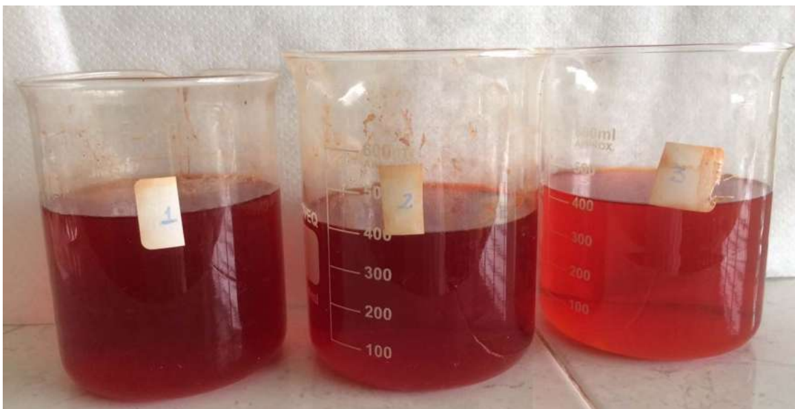
Figura 17: Agua resultante de la decantación.
