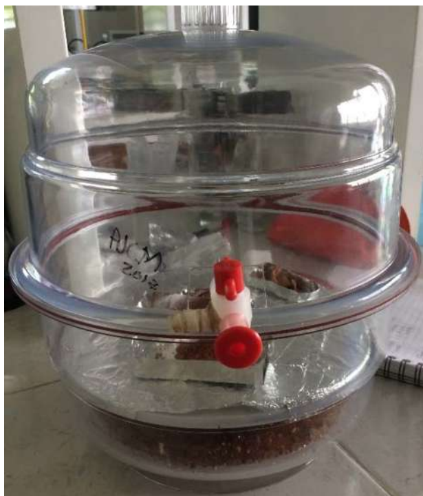
Figura 30: Muestras de hueso de aguacate en el desecador para determinación de humedad.
