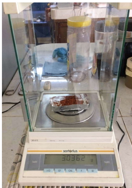
Figura 31: Pesado de muestras para determinación de la humedad del hueso de aguacate.
