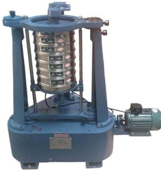
**Figura 3.3** Equipo para tamizar (Rotap)
