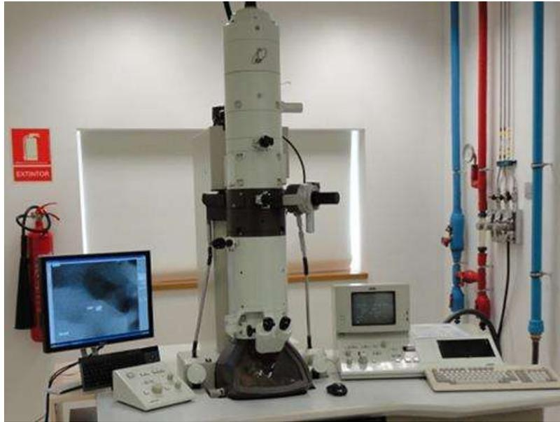
Fig. 6. Microscopio electrónico de transmisión JEM-2010F.
