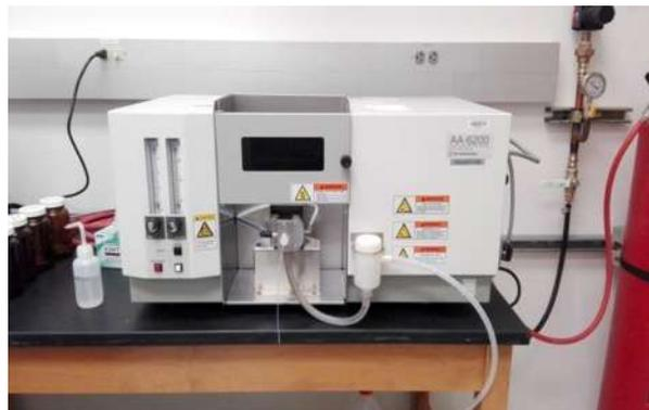
Figura 13. Espectrofotómetro de absorción atómica (EAA).
