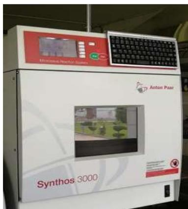
Figura 3 Equipo de microondas Synthos 3000 de Anton Paar.
