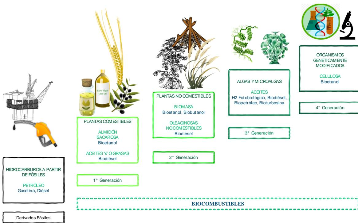
Figura 5. Clasificación de los biocombustibles líquidos.
