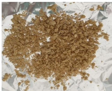
Fig. 24. Restos sólidos de cáscara de naranja sin humedad para la muestra con relación en peso 1:2 (sólido/ agua destilada, P/P).
