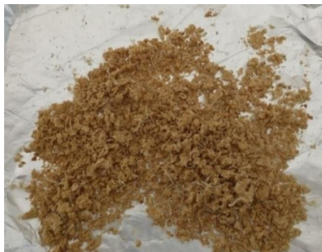
Fig. 23. Restos sólidos de cáscara de naranja sin humedad para la muestra con relación en peso 1:2 (sólido/ agua destilada, P/P).
