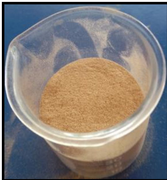
Fig. 16: Endocarpio de coco tamizado en una malla de 180 micras.
