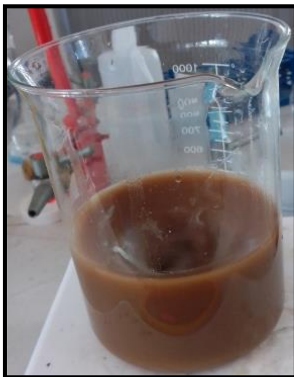
Fig. 20: Endocarpio de coco deslignificado impregnándose en solución de Ac-Mg.
