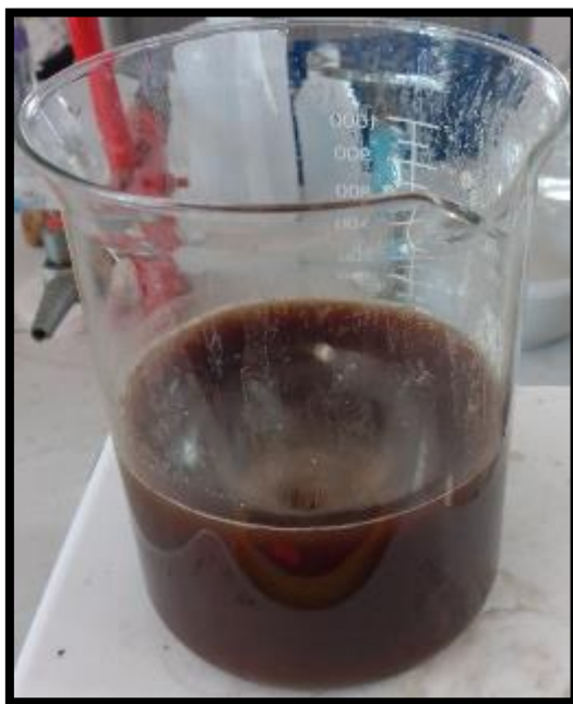
Fig. 18: Deslignificación del endocarpio de coco.
