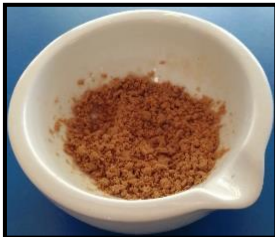
Fig. 21: Endocarpio de coco impregnado con Ac-Mg.
