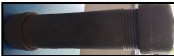
Fig. 22: Reactor tubular de acero inoxidable para carbonización.
