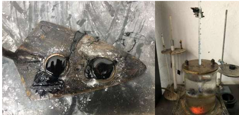
Figura 11. Molde y proceso prueba de Punto de Reblandecimiento
