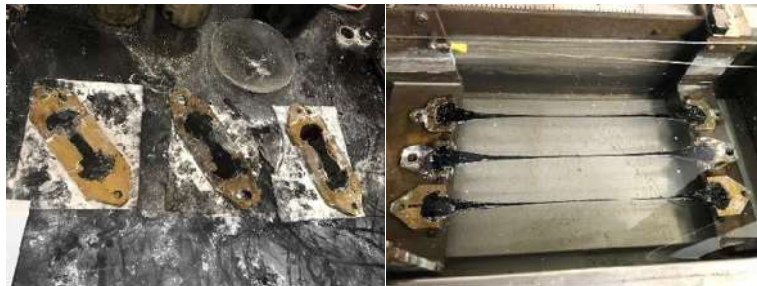
Figura 10. Moldes y proceso de Prueba Ductilidad
