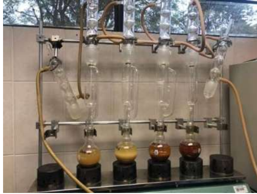
Figura 7. Extractor Soxhlet, propiedad del LIDA
