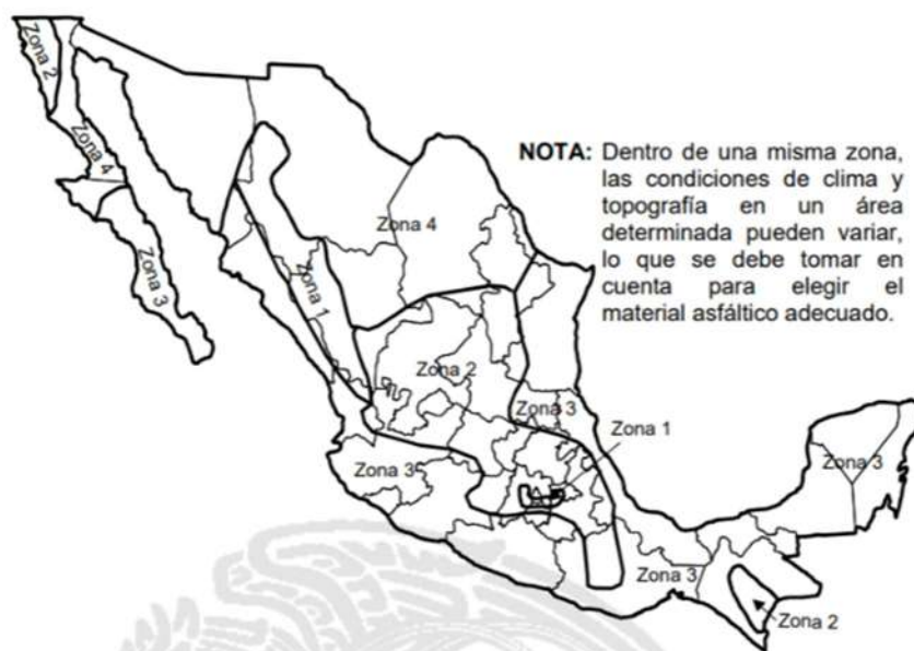
Figura 23. Mapa de región geográfica para la utilización de asfaltos en México. Nota: Reproducida de Regiones geográficas para la utilización de asfaltos clasificados según su viscosidad dinámica a 60 °C, SCT, N-CMT-4-05-001/05.
