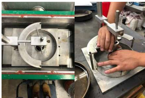
Figura 13. Proceso prueba Recuperación Elástica por Torsión
