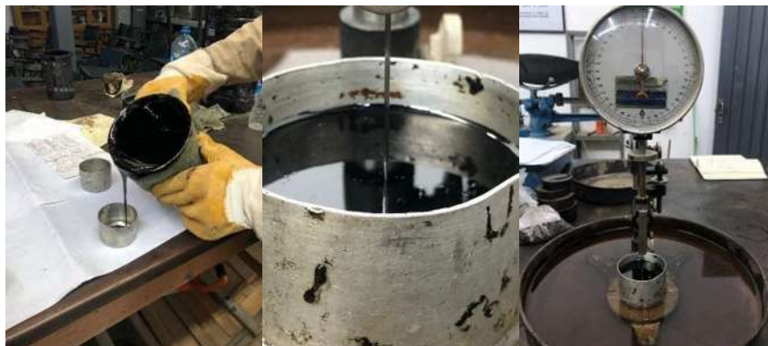
Figura 12. Molde y proceso de prueba Estándar para la Penetración de Materiales Bituminosos
