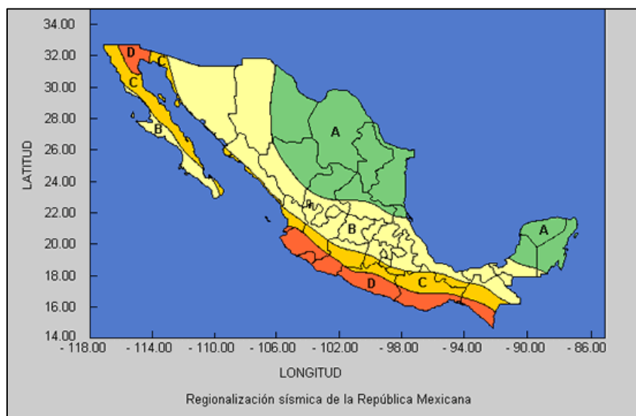
Figura 5.2 Regionalización sísmica de México. Tomada de https://hoffman-latam.com/blog/regiones-sismicas-en-mexico/
