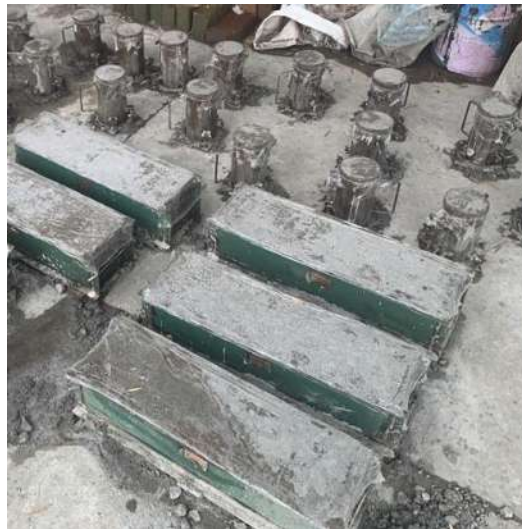
Ilustración 33. Especímenes cubiertos para conservar la humedad.
