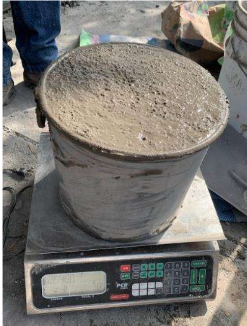
Ilustración 24. Determinación de la masa unitaria del concreto fresco.
