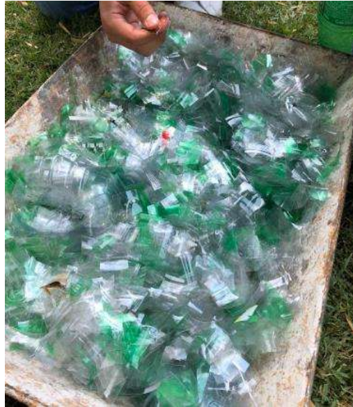
Ilustración 16. PET en el proceso de cortado en láminas.
