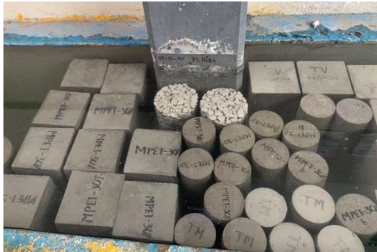
Ilustración 38. Diferentes especímenes de mezclas en la pila de curado.
