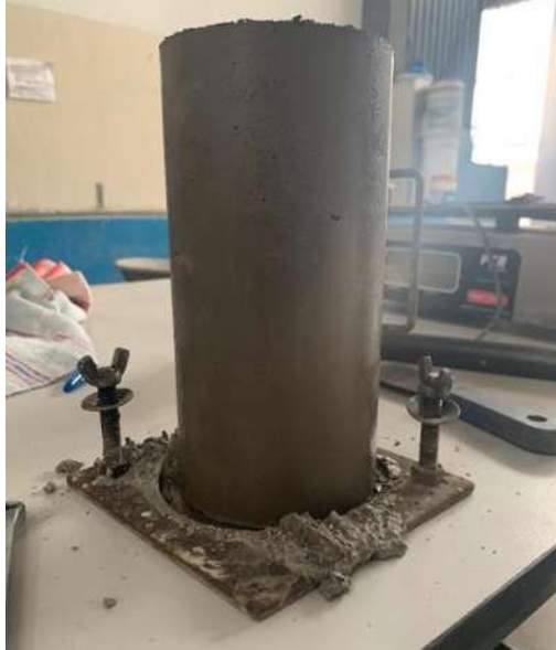
Ilustración 34. Descimbrado de especímenes.
