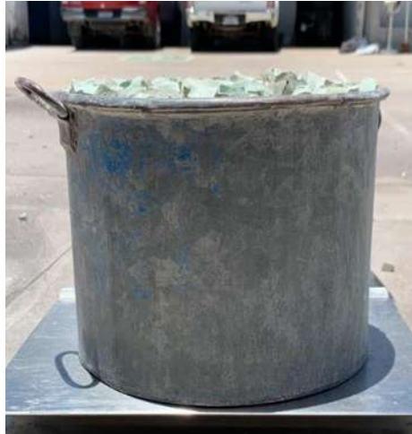
Ilustración 9. Masa volumétrica del PET.
