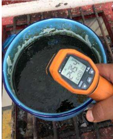
Ilustración 17. Medición de temperatura del PET en estado líquido.
