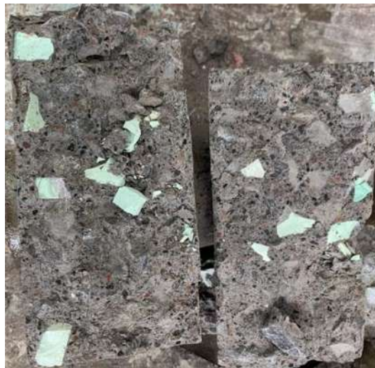
Ilustración 55. Cilindro abierto con mezcla MPET-15%.
