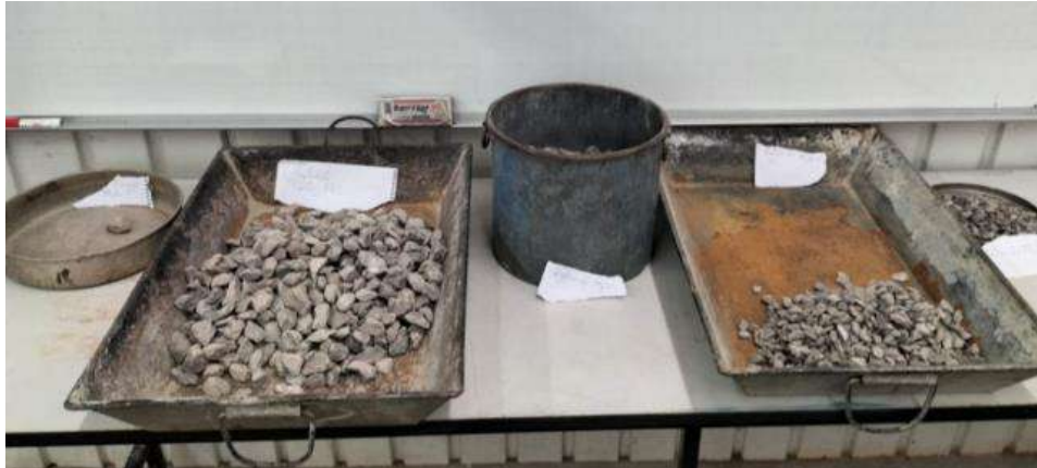
Ilustración 15. Material grueso retenido en mallas.
