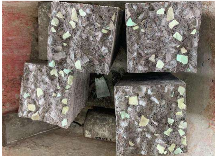
Ilustración 53. Resultado de viga a flexión de 30% con PET.
