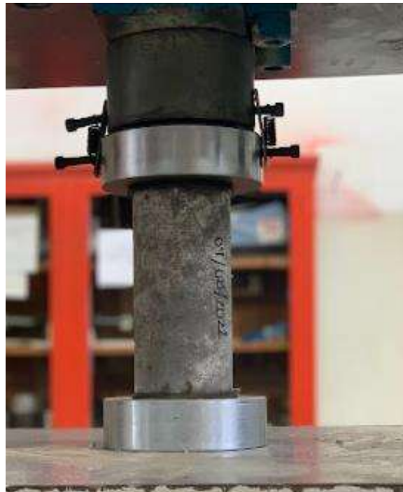
Ilustración 40. Aplicación de la carga axial a cilindros de concreto.
