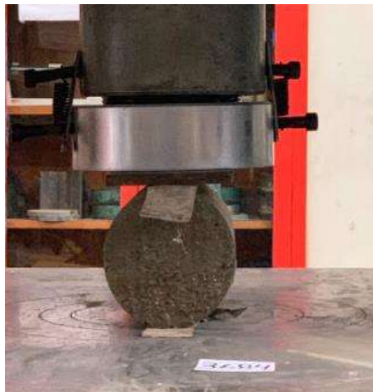
Ilustración 45. Especimen colocado en la máquina universal.
