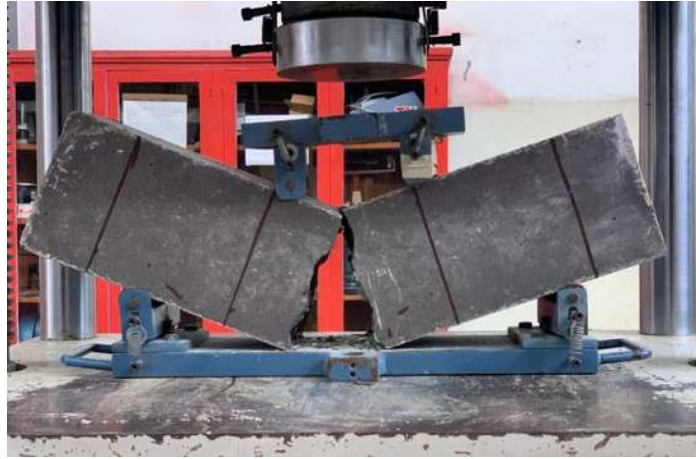
Ilustración 42. Desarrollo de la prueba de flexión en vigas en estudio.
