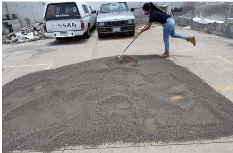
Ilustración 13. Tendido de arena para tomar la muestra.
