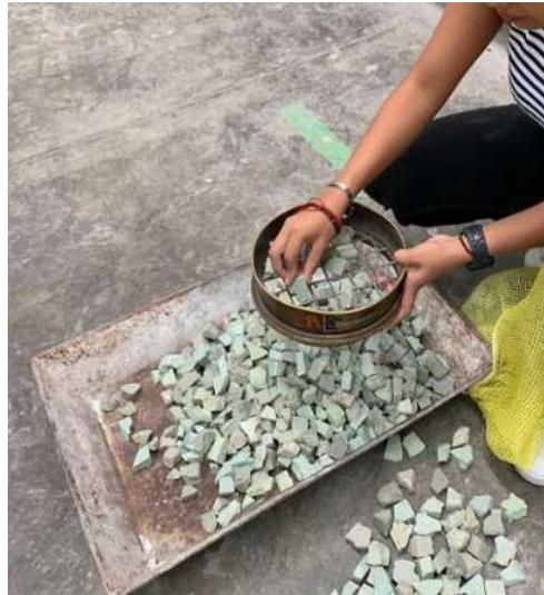
Ilustración 21. Cribado del PET por malla \frac{3}{4} de pulgada.
