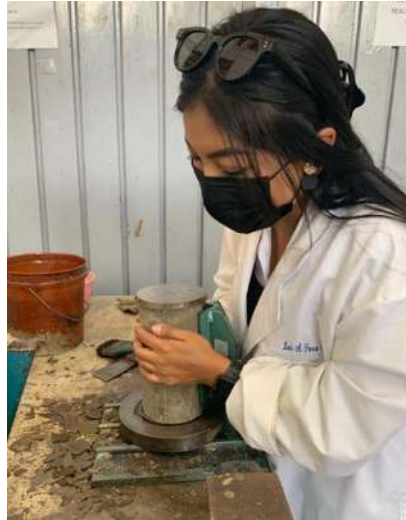
Ilustración 39. Realización del cabeceo de especímenes. (Fuente propia)
