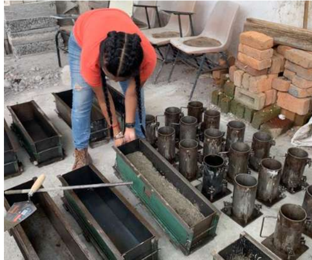
Ilustración 30. Golpes contra el piso en moldes prismáticos.
