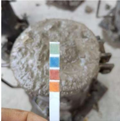
Ilustración 25. Determinación del pH de la mezcla de concreto.
