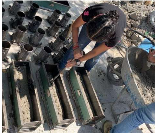
Ilustración 29. Varillado para la compactación de la mezcla.
