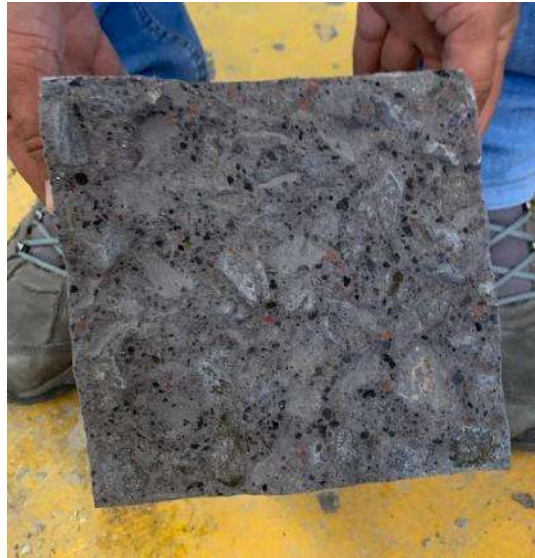
Ilustración 51. Resultado de flexión de mezcla testigo.
