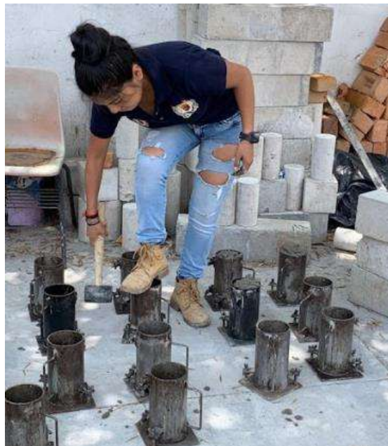
Ilustración 31. Golpes en el molde para la eliminación de burbujas de aire.
