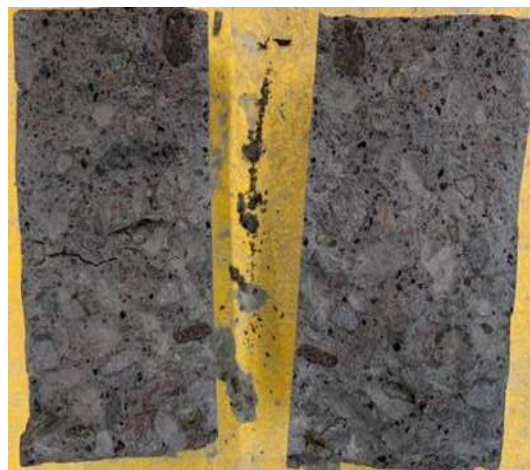
Ilustración 54. Cilindro abierto de mezcla testigo.
