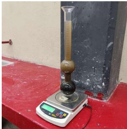
Ilustración 5. Agregado grueso en picnómetro
