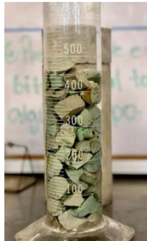
Ilustración 6 Cálculo del volumen del PET para la prueba de densidad.
