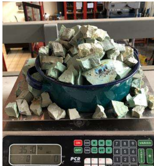
Ilustración 20. Pesaje del PET en estado sólido fuera del molde.
