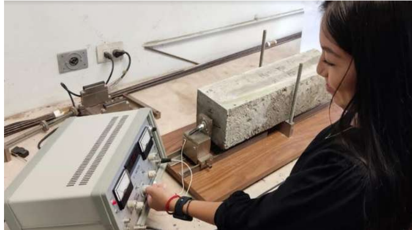
Ilustración 50. Frecuencia de resonancia en vigas de concreto.
