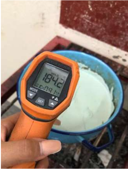
Ilustración 18. Temperatura del PET endurecido.
