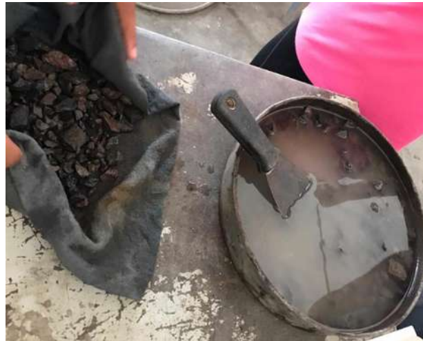
Ilustración 10. Material saturado y secado superficialmente.
