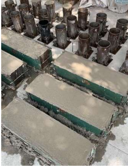
Ilustración 32. Enrasamiento de los especímenes.
