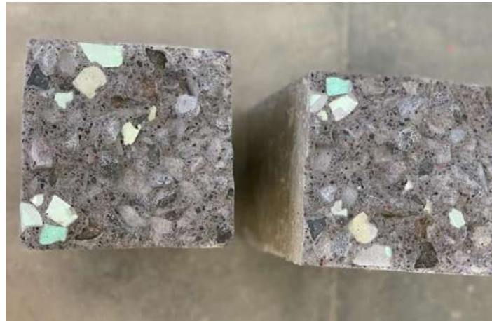
Ilustración 52. Viga a flexión con 15% de PET en sustitución.
