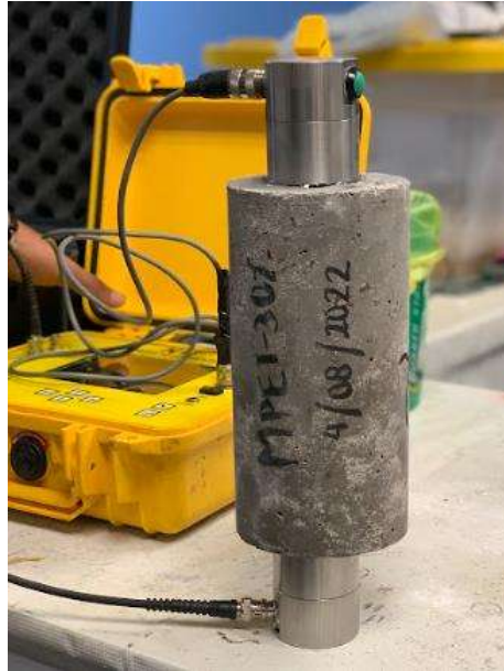
Ilustración 49. Prueba de VPU en cilindros de concreto.
