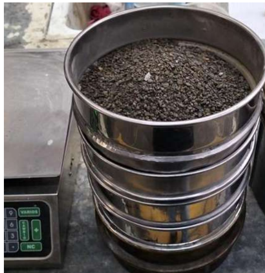
Ilustración 14. Material fino a través de mallas para granulometría.
