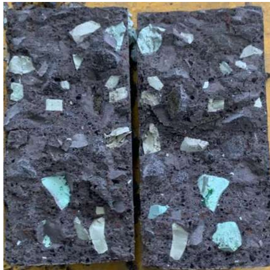
Ilustración 56. Cilindro abierto con mezcla MPET-30%.
