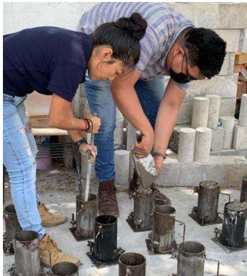
Ilustración 28. Vaciado de la mezcla en los moldes para su varillado.
