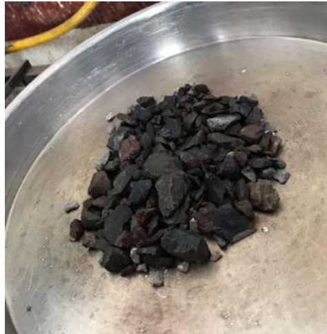
Ilustración 11. Secado del material grueso.
