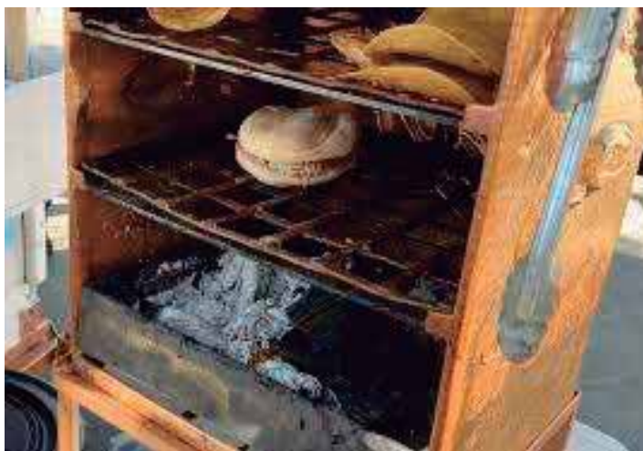
Imagen III.18. Horno de cobre para elaboración de la torta de Tostada.
