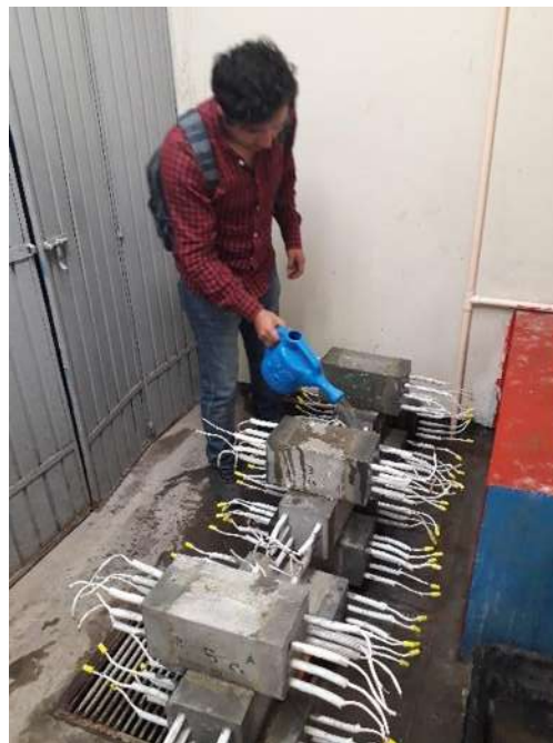
Ilustración 27 Curado de las muestras restauradas.
