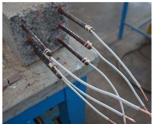
Ilustración 20 Colocación de los cables del #12 con cinchos dobles de nylon.
