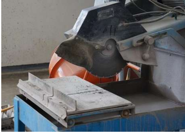
Ilustración 12 Máquina cortadora con la que se realizaron los cortes necesarios para el retiro de la sección a renovar.
