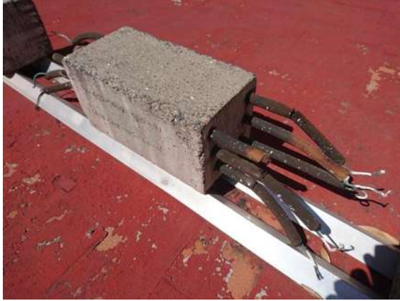
Ilustración 8 Probeta con varillas totalmente dañadas.
