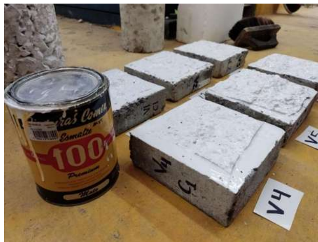
Ilustración 36 Preparación de las rodajas de concreto con esmalte para la protección al intemperismo.
