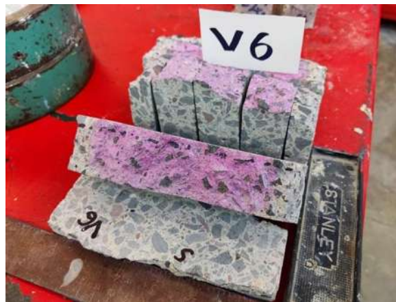
Ilustración 31 Muestras de concreto de especímenes carbonatados (correspondiente al esquema de la ilustración 30).
