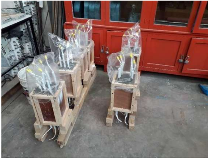
Ilustración 26 Muestras cubiertas con bolsas plásticas durante el proceso de fraguado.
