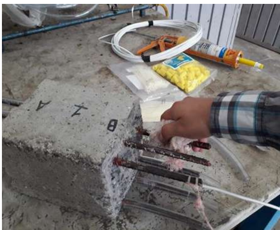
Ilustración 19 Limpieza final con una estopa con la que se remueven partículas finas de suciedad generadas durante la limpieza mecánica.
