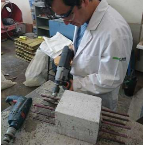
Ilustración 17 Limpieza mecánica de las barras cubiertas con sellador viejo.
