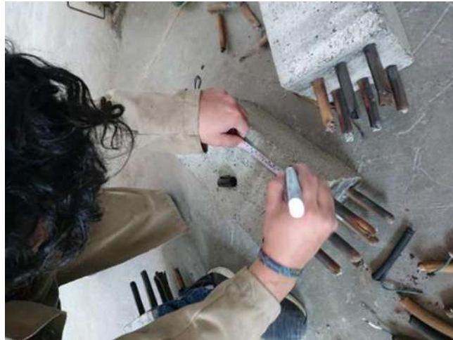
Ilustración 10 Delimitación de la superficie a cortar
