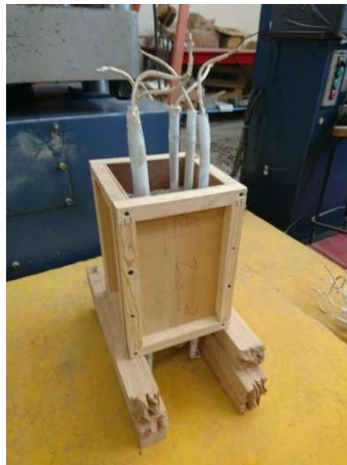
Ilustración 24 Preparación y nivelado de las probetas cimbradas para el colado de la sección restaurada.
