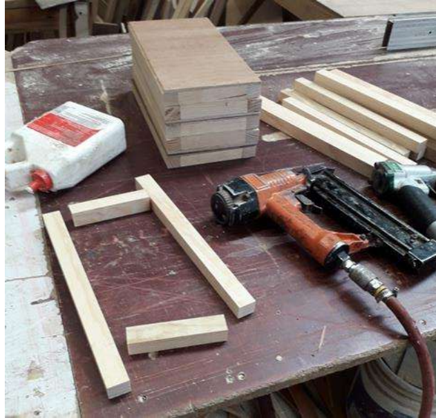
Ilustración 23 Elaboración de las cimbras para el colado de las muestras.
