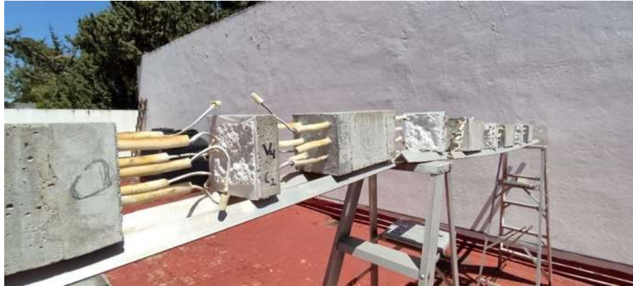
Ilustración 37 Colocación de los especímenes en la azotea para exposición al intemperismo.
