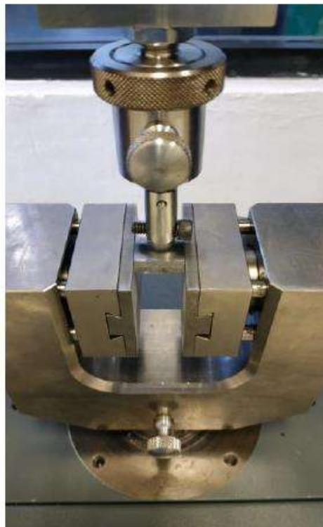
**Figura 35.** Equipo de tensión y compresión (Zwick/Roel) [7].
