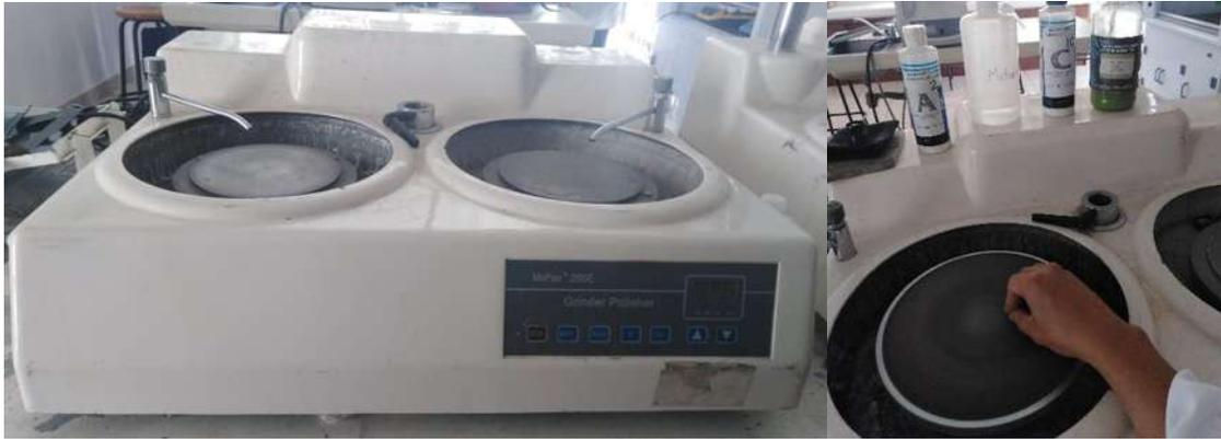
**Figura 18.** a) Pulidora Grinder Polisher, b) Técnica pulido espejo
