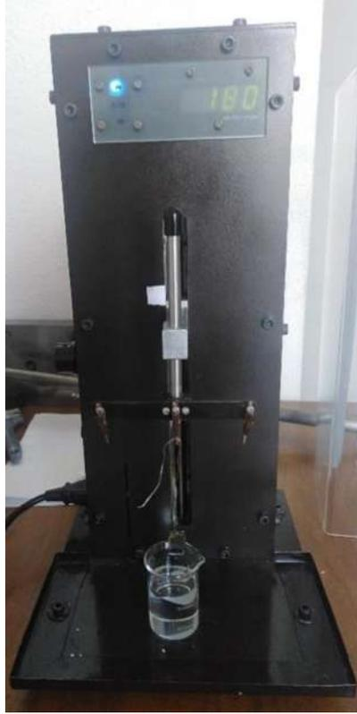
**Figura 31.** Aplicación del Recubrimiento por medio del método de Inmersión "Dip Coating".
