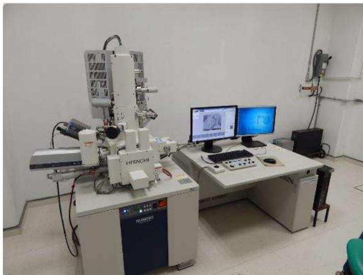
**Figura 40.** Microscopio electrónico de Barrido de Emisión de campo frio [9].
