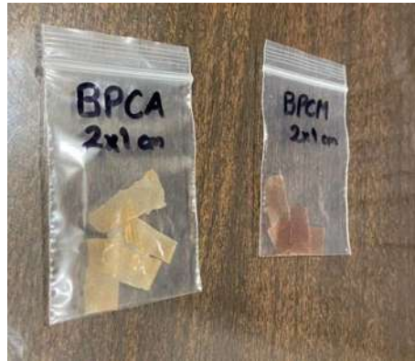
Figura 4.26. Muestras de tamaño 2x1 cm de la película bioplástica de camote amarillo (BPCA) y de la película bioplástica de camote morado (BPCM).
