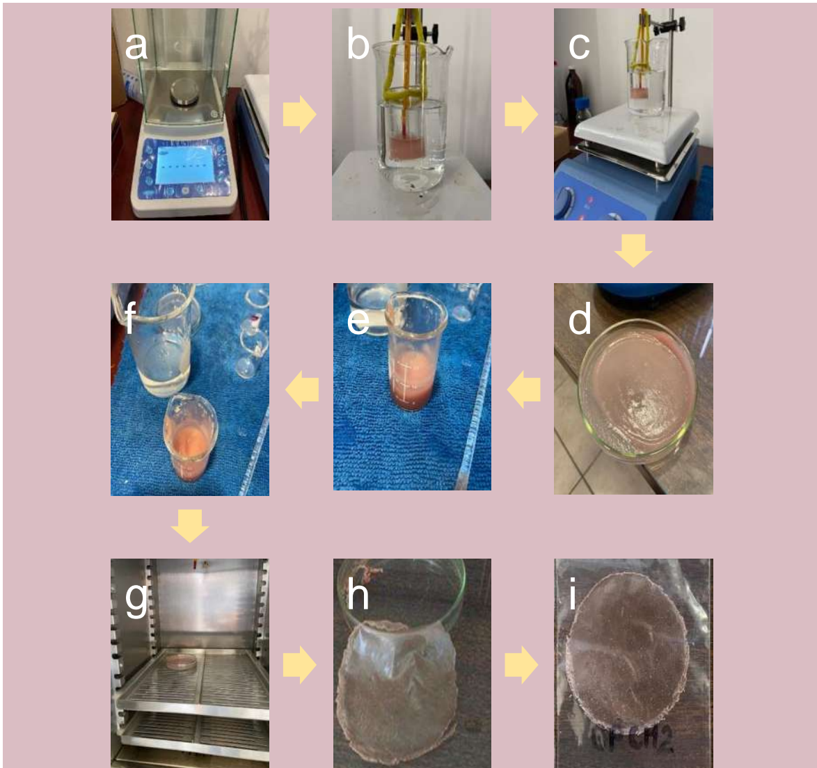
Figura 3.8. Metodología de preparación de la película bioplástica de camote morado (BPCM). Donde: a) Balanza analítica de precisión, modelo VE-204, b) Mezcla en baño María, c) Agitador magnético con placa calentadora, d) Mezcla retirada del baño María, e) Mezcla gelatinizada, f) Mezcla esparcida en caja de Petri, g) Caja de Petri con mezcla en mufla, h) Película bioplástica de camote morado (CM), i) Película bioplástica de camote morado (CM) en bolsa de muestra.
