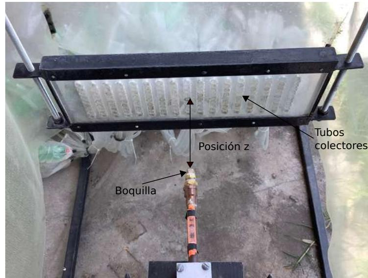
Figura 4.6: Distancia  $z_s$  entre boquillas y tubos colectores.
