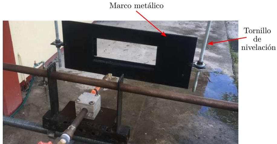
Figura 4.9: Arreglo experimental para la colocación de la placa caliente.
