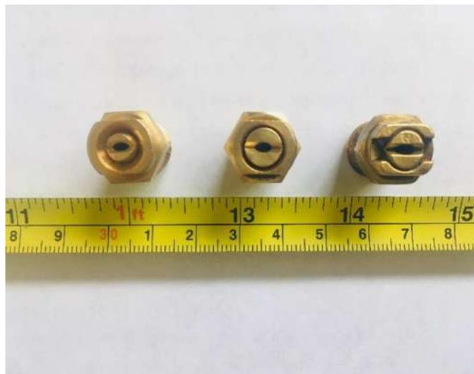
Figura 4.5: Boquillas hidráulicas empleadas. Lechler 632.604 (izquierda), Lechler 632.644 (centro) y Lechler 632.646 (derecha).
