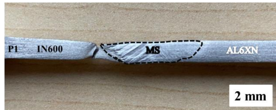
Figura 4. 18. Imagen de la probeta fracturada de la unión disímil donde se observa la zona de fractura en la aleación Inconel.
