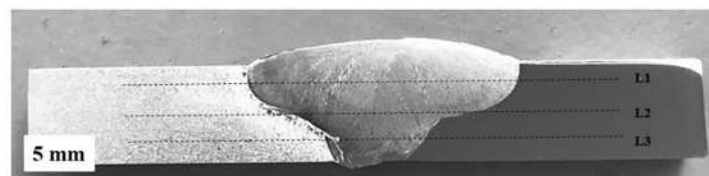
Figura 4. 16. Macrografía con señalización de las líneas en las que se realizaron los barridos de microdureza.
