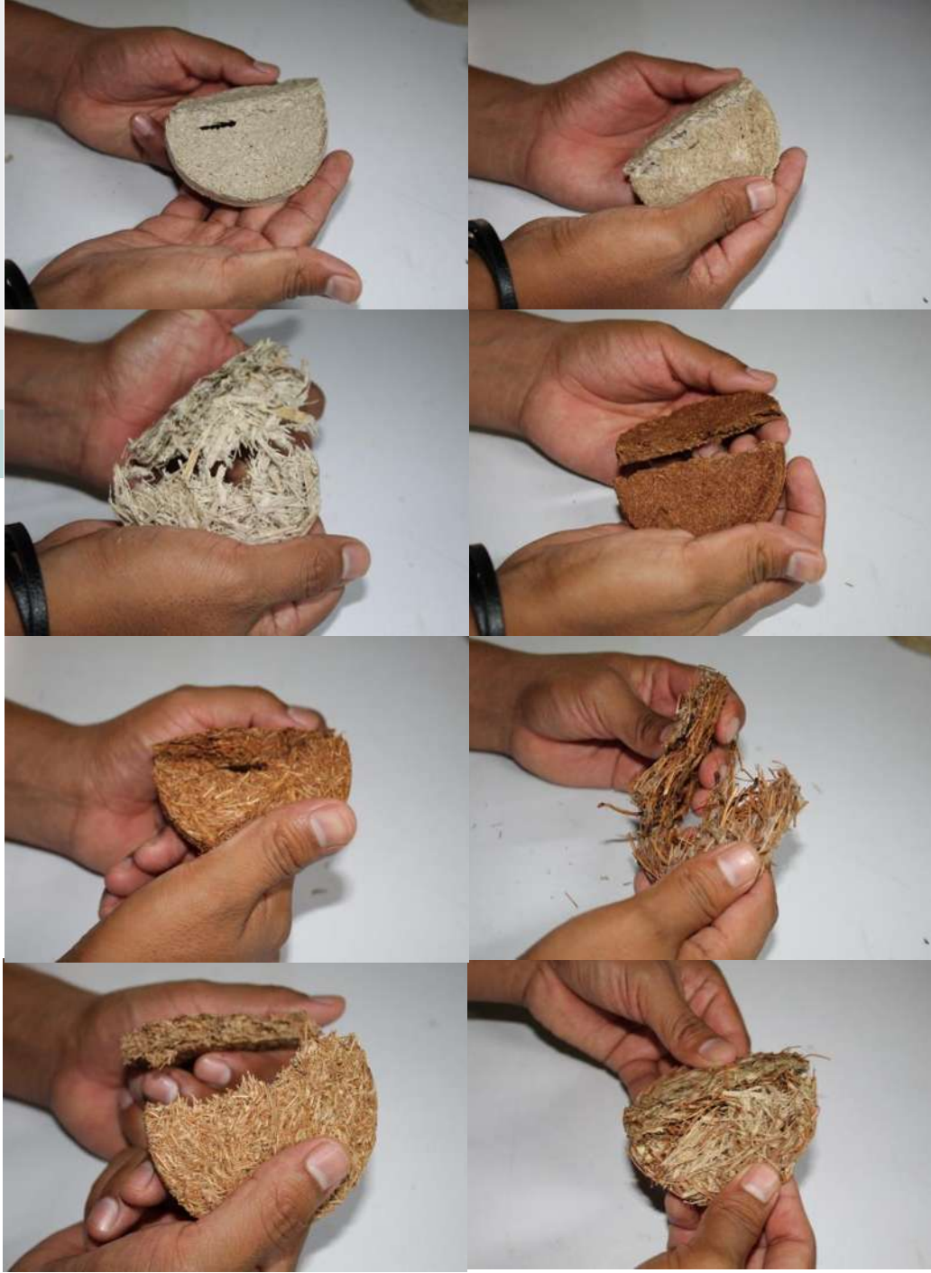
Fig. 00 Fotografías de la aplicación de la prueba de resistencia a la flexión. Fuente: propia.
