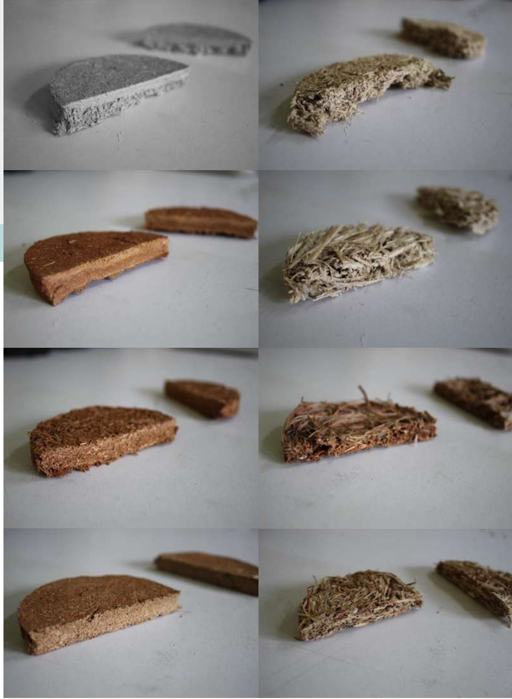
Fig. 00 Fotografías de la aplicación de la prueba de resistencia al corte. Fuente: propia.
