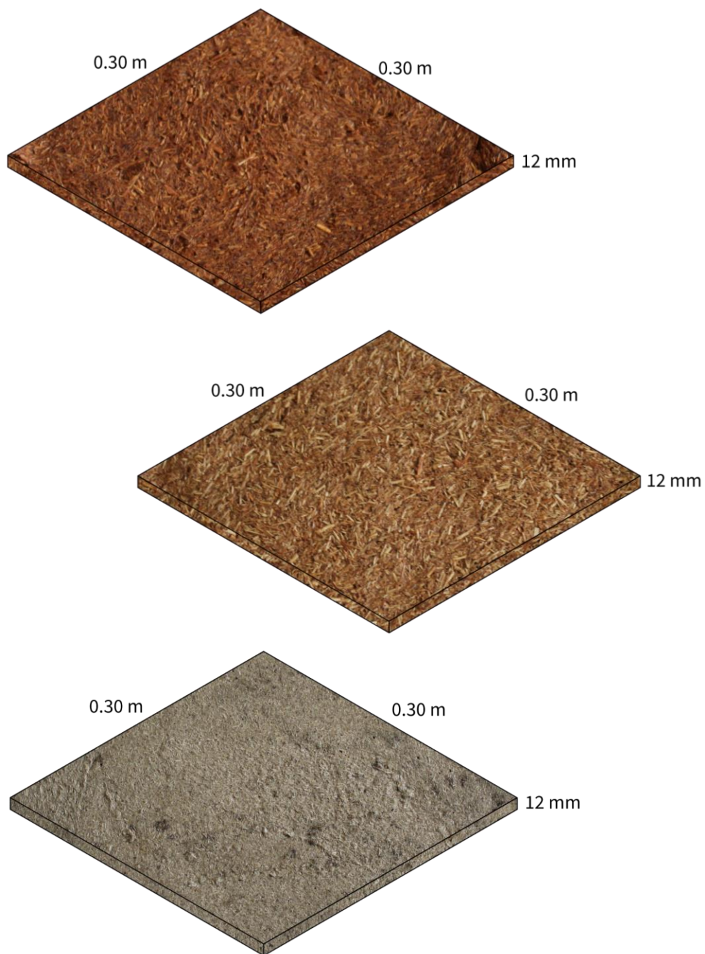
Fig. 100 Prototipos de panel de aglomerado del biomaterial de 30x30 cm. Fuente: propia.
