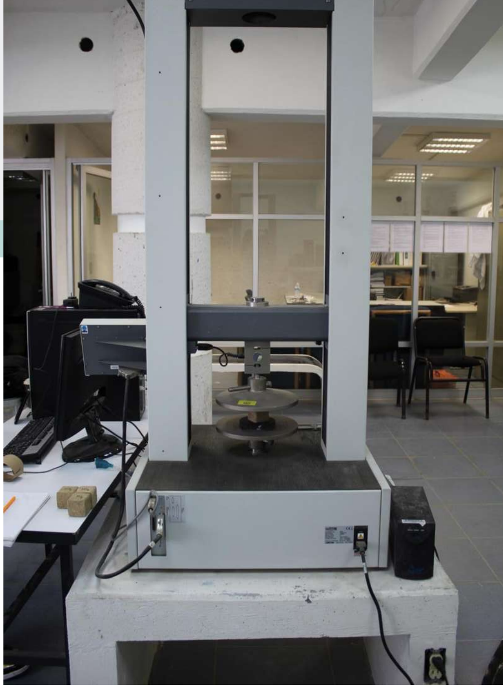
Fig. 00 Equipo especializado para pruebas de compresión del laboratorio de la FAUM. Fuente: propia.
