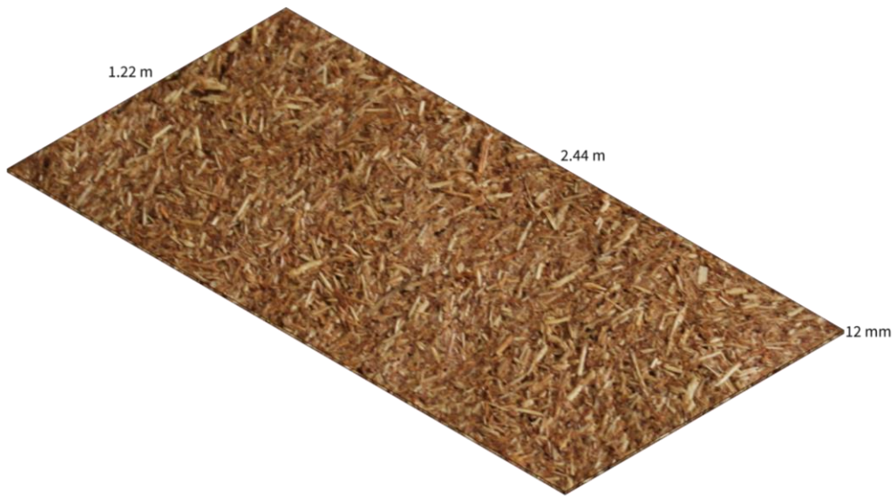
Fig. 00 Especificación de un panel de medida comercial. Fuente: Propia
