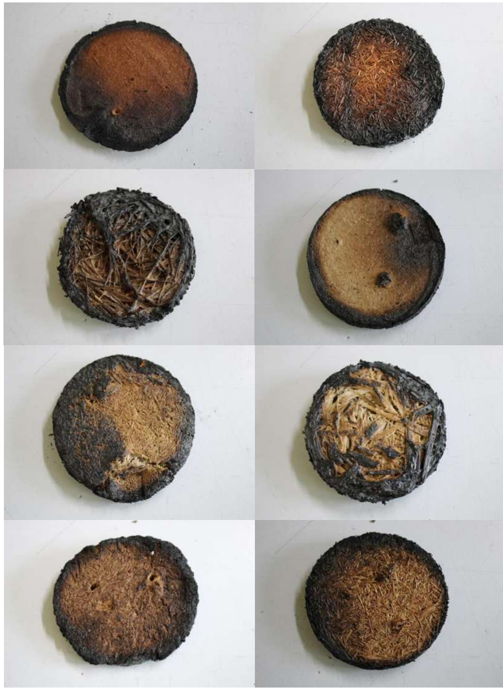
Fig. 00 Fotografías de la aplicación de la prueba de resistencia al fuego. Fuente: propia.
