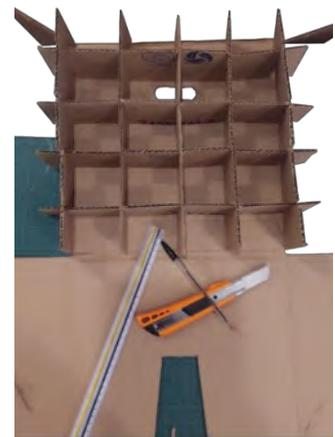
Fig. 261.0 Trazo y corte de refuerzo longitudinal
