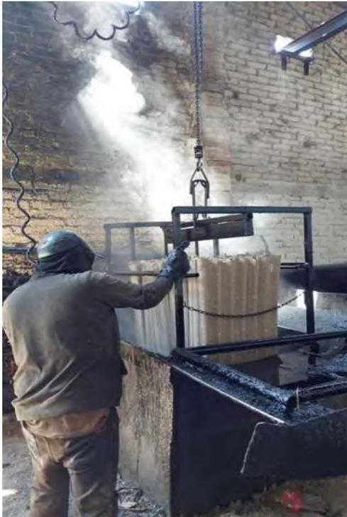
Fig. 37.0 Paso 9. Las láminas son cubiertas con combustolio sólido
