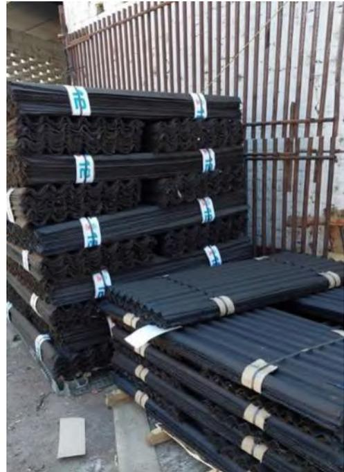
Fig. 40.0 Paso 12. Se seleccionan y empaquetan las láminas para venta
