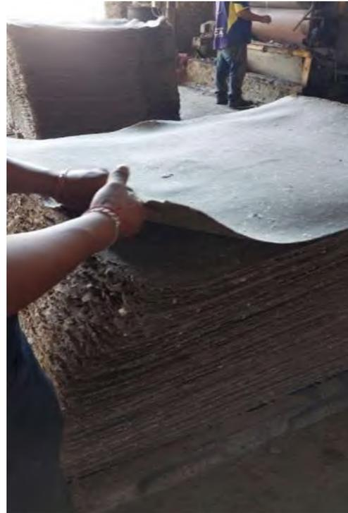
Fig. 34.0 Paso 6. Se transforma en láminas y se dejan secando
