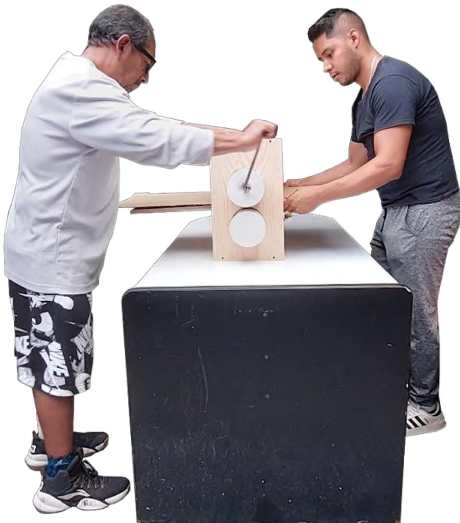
Fig. 443.0 Diagrama de creación de plantilla mediante suaje y suajadora
