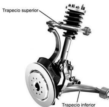
Figura 2.8: Trapecio o Brazo de suspensión
