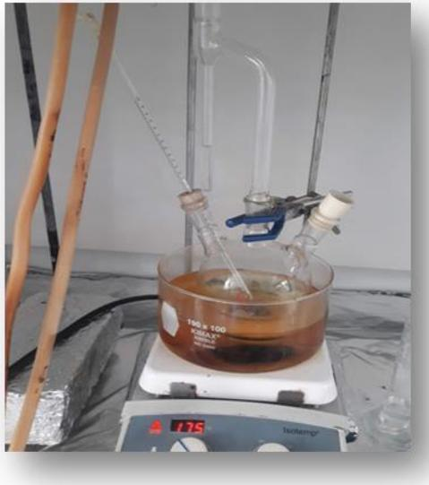
*Fig.7 Experimento 2. Equipo experimental de Dean Starck para esterificación con agitador magnético.*
