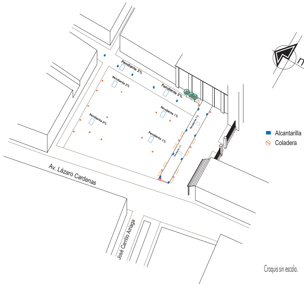
FIGURA N° 2 UBICACIÓN DE ALCANTARILLADO.
