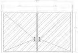
**P-1 y P-6** Puerta de vidrio de 19mm de espesor, con batidor de aluminio, con un acabado de pintura de esmalte.
