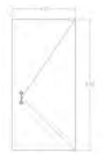
P-3 Puerta. Puerta de tambor, con bastidor de madera de pino de 1/2" x 2", forrada con triplay de 5,00 mm de espesor, con madera de pino, acabado con pintura de esmalte y barniz natural
