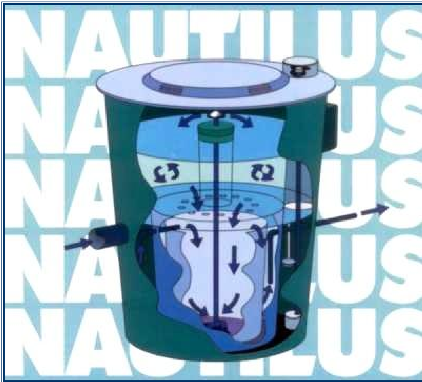
Fig. 14 Planta de Tratamiento aerobio de aguas residuales para casas y departamentos con capacidad para flujos entre 1250 y 8750 LPD con almacenamiento y estabilización anaerobia de lodos. Calidad de agua tratada de acuerdo con la norma: NOM 003 ECOL 1997.
