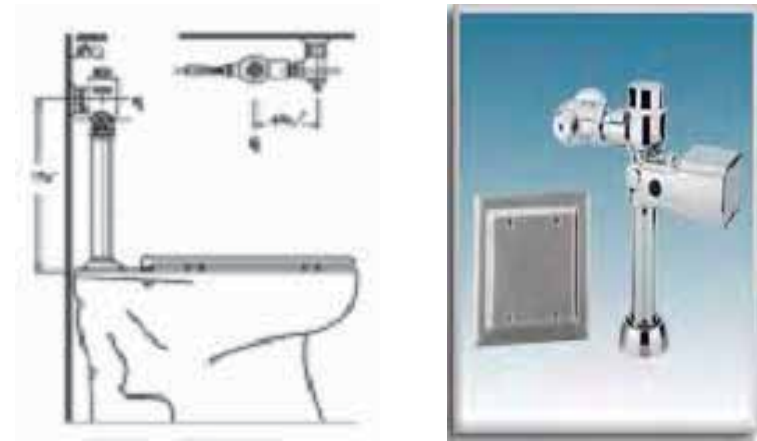
Imagen 065: Fluxómetro de censor electrónico de embolo de corriente para W.C. de 32 mm con botón accionador mecánico.
