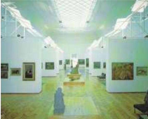
La luz directa tiene problemas de expedir calor sobre el objeto sobre todo si se utilizan lámparas incandescentes la siguiente imagen nos muestra un ingeniosos sistema aplicado en un museo de Suiza que aminora la luz incidente y el calor de las lámparas: estas han sido montadas en la parte superior de los exhibidores y proyectan la luz contra pantallas móviles que atenúan la intensidad y el resplandor.
