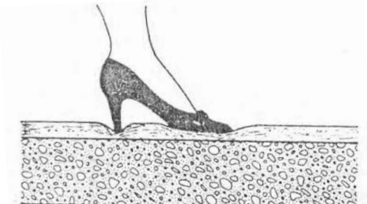
Imagen T-a20. Arquitectural acustics, JOHN WILEY & SONS. INC. Usa1949. Un revestimiento de suelo atenúa los ruidos de paso, podemos aplicar alfombras o algo similar que estará trabajando de dos formas, una, es absorber los ruidos que en ella chocan creados por la fuente sonora, y la otra atenuar los ruidos de paso o ruidos de impacto, de ante mano sabemos que para el ultimo caso es difícil el control total ya que el piso tramite vibraciones y la alfombra no alcanzaría evitar tanto impacto.
