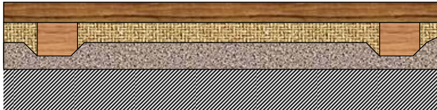
Parquet sobre durmientes flotantes.
