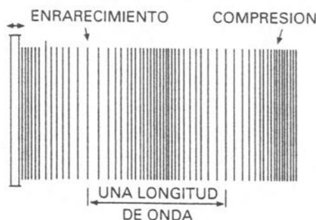
(Grafica 2.b) La generación de ondas sonoras Por una superficie vibrante.
