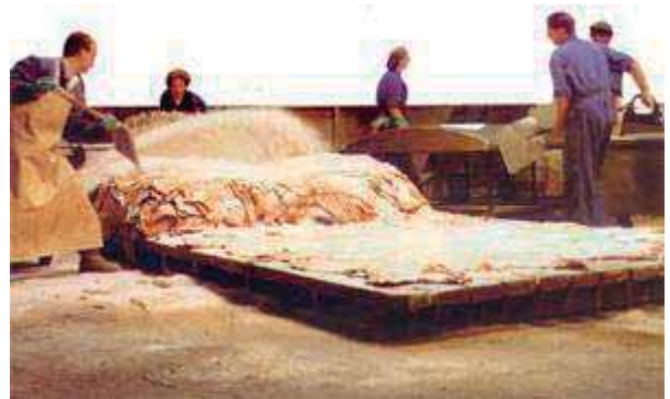
(Fig. 025) proceso del Salado de la piel. 8
