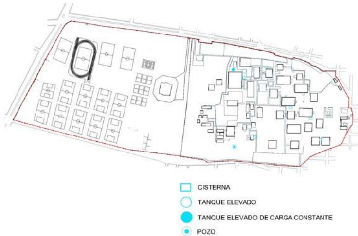
UNIVERSIDAD MICHOACANA DE SAN NICOLAS DE HIDALGO Red de Agua Potable Actual
