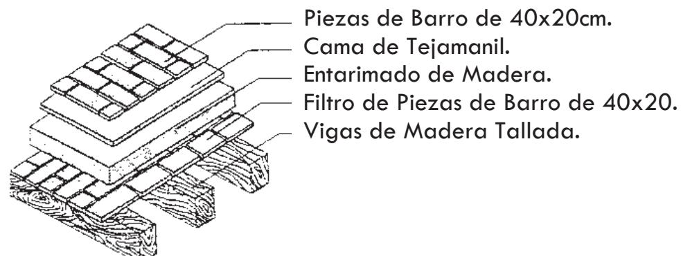
**Techos inclinados.** Sistema constructivo a una y dos vertientes, formado a base de una estructura con vigas y largueros de madera labrada; primero se clavan los largueros sobre las vigas, después se coloca una capa de madera delgada o tejamanil, para evitar las filtraciones o el polvo, y por ultimo, se colocan las tejas en seco.
