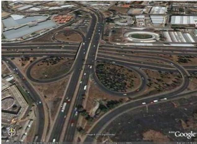
Fig. 2.20. Ejemplo de intersección de Trébol Parcial.
