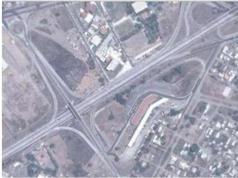
Fig. 2.23. Ejemplo de intersección de diamante.
