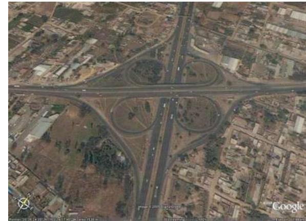
Fig. 2.22. Ejemplo de intersección de Trébol Completo.
