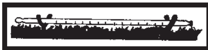
IMAGEN 35.- Termómetro de Mínima sobre hierba
