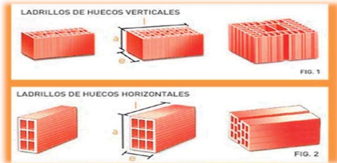
Ilustración 13, imagen que muestra las formas y dimensiones del ladrillo hueco.
