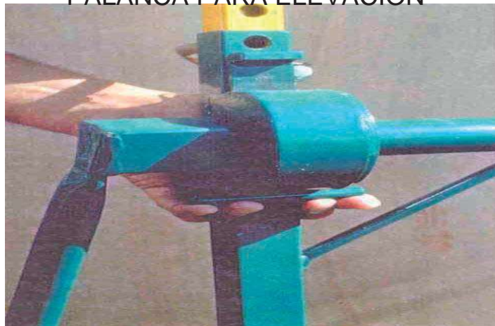
SEGURO LEVANTADO PARA BAJAR EL ANDAMIO
