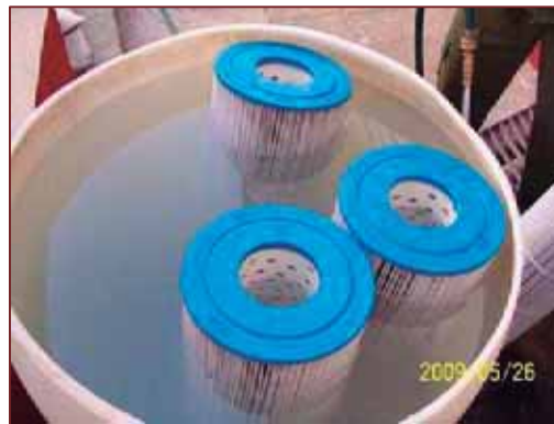
Imagen: cartuchos del filtro en proceso de lavado y sumergidos en flik.
