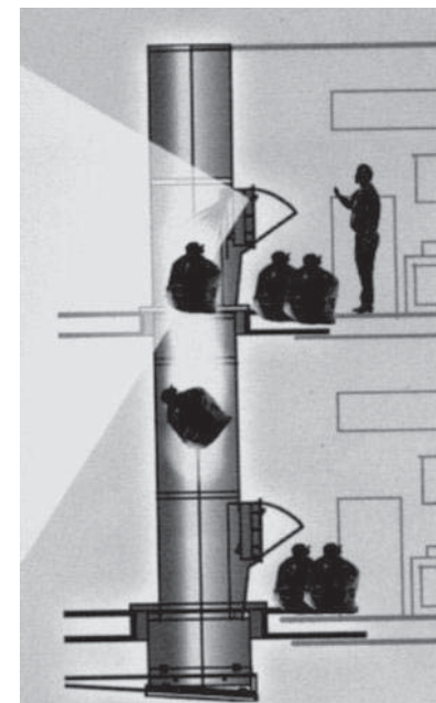
Fig. 87. Ducto de basura con separador. Imagen de: www.verticalsne.com.mx
