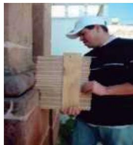
Fig. 35. Levantamiento de molduras con peine de madera. Fuente: Santibáñez Ivett, diciembre 2009.
