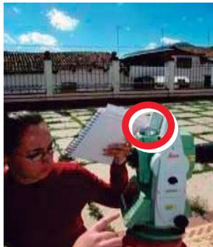
Fig. 18. Orientación de la estación hacia un azimut conocido, en este caso el norte, con ayuda de la brújula. Fuente: Santibáñez Ivet, enero 2010.
