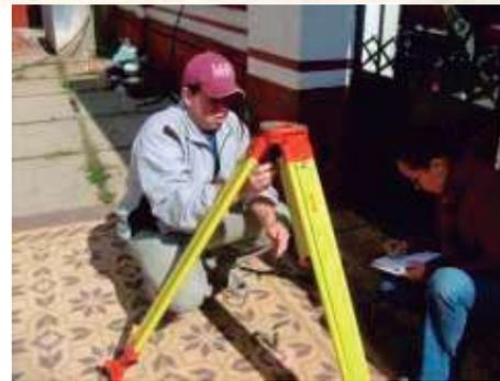
Fig. 10. Ubicación del trípode en el Banco de estación con ayuda de la plomada física. Fuente: Santibáñez Ivett, enero 2010.
