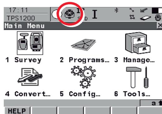
Fig. 19. Pantalla donde se indica la función de Prisma o Láser (TPS1200 Total Station. USER'S GUIDE)
