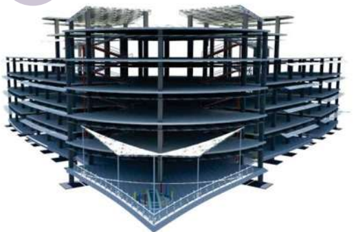
IMAGEN 80.- PROPUESTA ESTRUCTURAL PARA LA ESCUELA DE ARQUITECTURA, LAS FOTOS MUESTRAN EL CRITERIO ESTRUCTURAL PARA EL PROYECTO. IMAGEN R.B.J.
