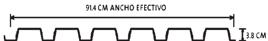
Imagen 42 de corte de lamina galvanizada de la marca galvadeck 111
