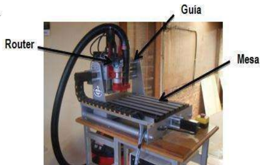
Fotografía de la mesa router cnc señalando las diferentes partes de la máquina.
