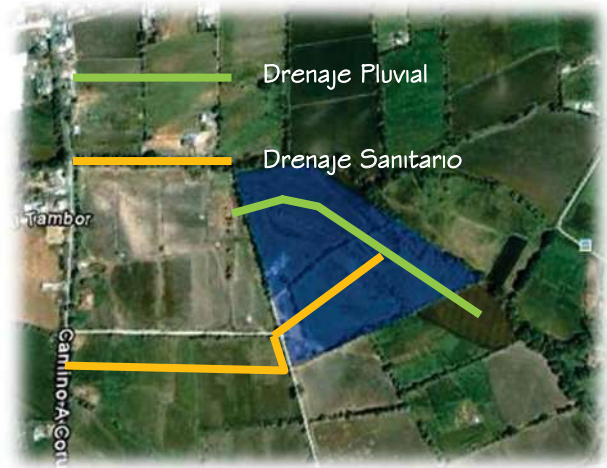
Imagen 3.9 Se observan las líneas de drenaje Sanitario y Pluvial dentro del terreno.
