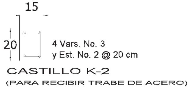
Imagen 20.- Vista en planta del armado del castillo K-2
