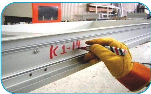
Foto No. 76 Nomenclatura por modulo
