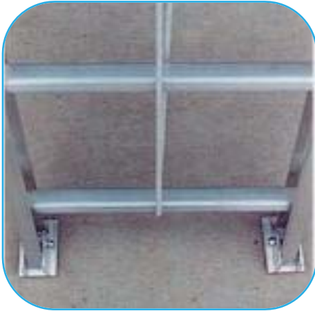
Foto 122 escalera con patas antiderrapante
