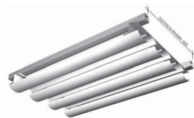
Imagen 64.- Forma de instalación del cortasol sunline.
