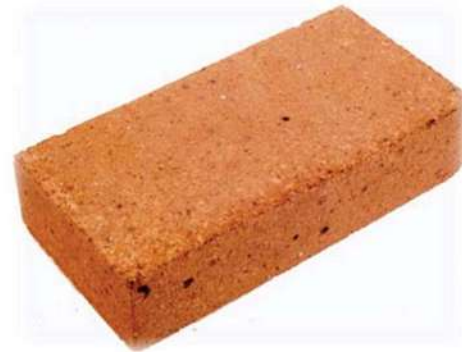
Imagen 58.- Tabique rojo recocido utilizado para la elaboración de muros.
