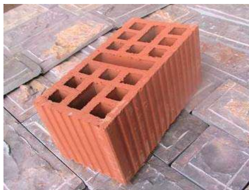
Imagen 60. El ladrillo extruido posee propiedades termo-acústicas
