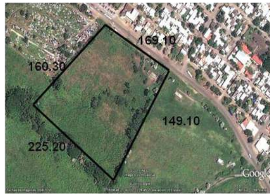
Fig.28 Dimensiones del 1er. terreno Autor [Google Earth]
