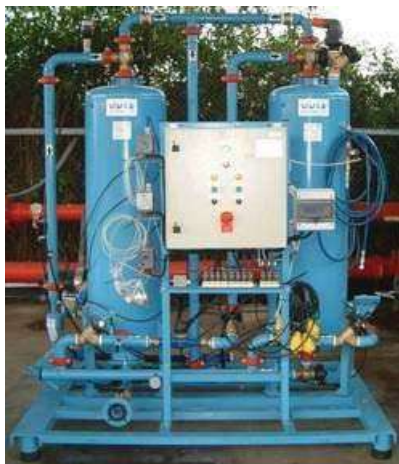
IMAGEN 6.4 SISTEMA ODIS OPTIMUM RECICLAJE DE AGUAS JABONOSAS
